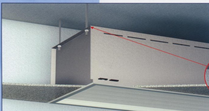
Dettaglio di fissaggio delle barre di sospensione
